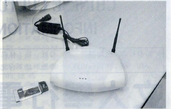
無線網路漫遊基地台(右)體積小，可以遍佈校園各角落；筆記型電腦插上無線網路卡(左)，全校師生即可無線上網。
