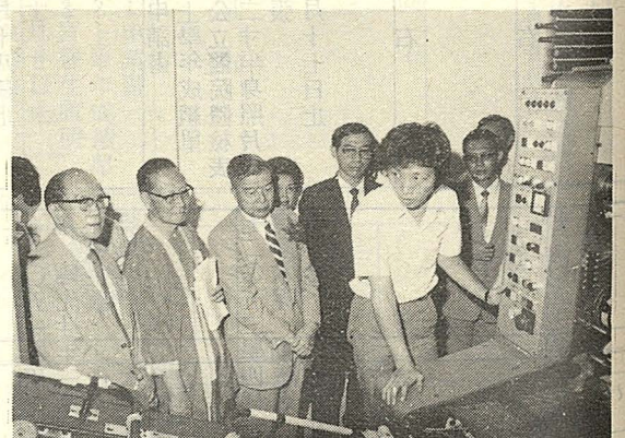
△圖為平版機房組長王衛明為參觀者說明雙色反轉印刷機的功能。王組長表示，這部機器不僅可快速雙面反轉印刷，而且印刷品質精美，同時有絕佳的安全自動裝置，如果紙張沒放好，手不慎機器運轉時，不惟機器運轉時有多快，馬達都會迅速自動停止，工人可以在安全環境中愉快地與機器配合，效率自然提高。（蕭一鳴攝）
