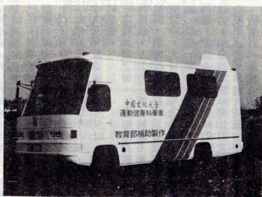
在於其車體有母車體與子車體之特殊技術與功能，亦即子車可由母車體向外側延伸增加使用的空間，車體未打開前寬度為二公尺二十五公分、打開後總寬度增加為四公尺十五公分，科學車內共有血壓計、肺活量、皮脂厚、俯臥後仰、坐姿體前彎、全身反應、平衡、握力、背肌力、登階、身高體重計、垂直跳、反覆橫跳等十四項體適能測驗機種。
